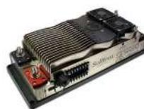
Prototipo di VCU specifica per la comunicazione con il powertrain elettrico.
