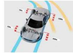
Creare un codice MATLAB-Simulink per generare differenti forze trazione su ogni ruota (torque vectoring), con la strumentazione stock di un veicolo di serie
