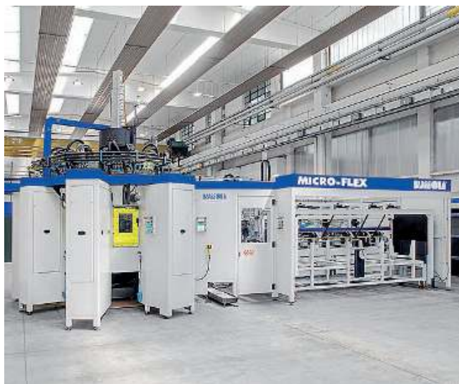
Micro-Flex. Da Buffoli, macchina con moduli a 3 assi e morse rotanti per pezzi di alta precisione in ottone senza piombo lavorati a secco
