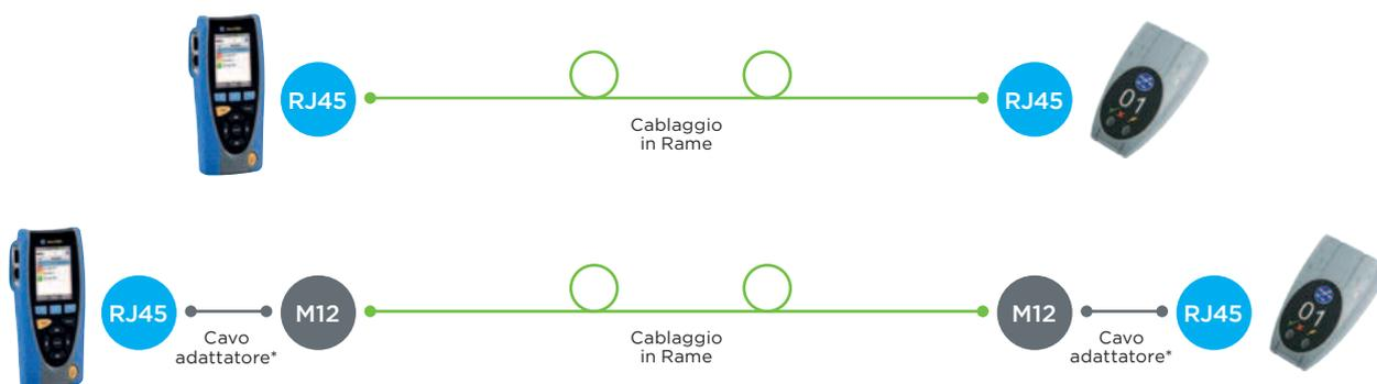
2 x 2 cavi con connettori M12 D forniti di serie.
